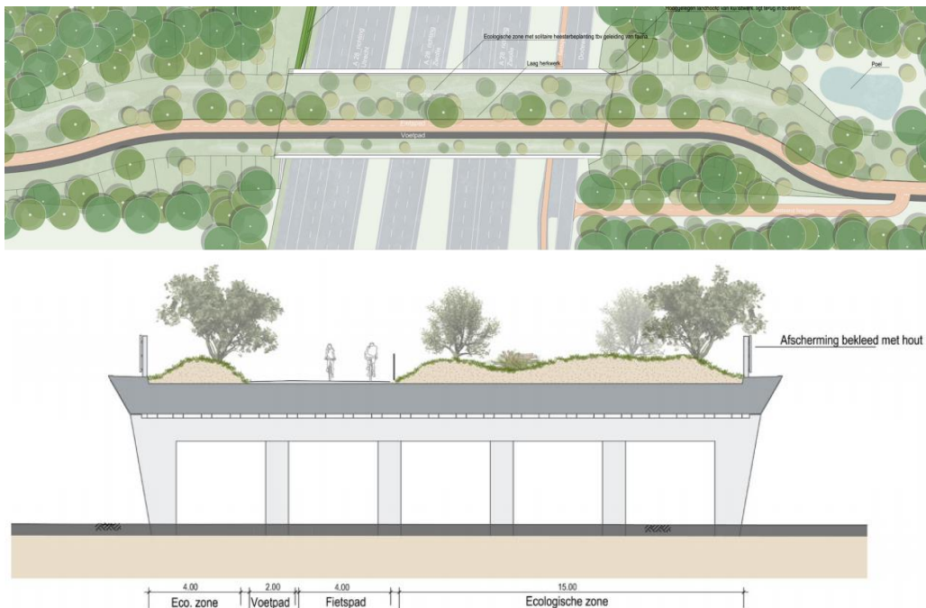
Afbeelding 10 Ontwerpschets van het ecorecreaduct Paradijsweg met bovenaanzicht (boven) en dwarsprofiel (onder). Zie Landschapsplan voor meer gedetailleerde weergave.
