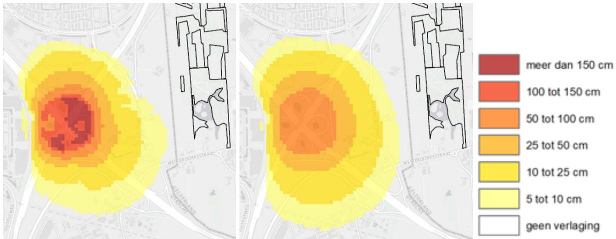
Figuur 15: Verlagsingscontouren voor de GHG (links) en de GLG (rechts)
