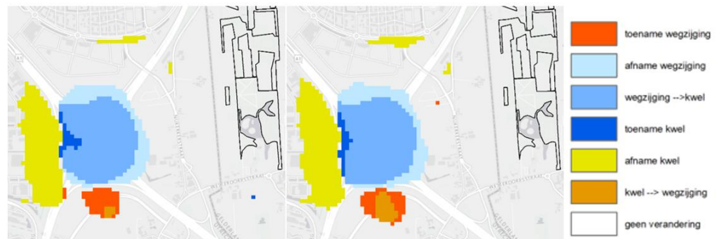
Afbeelding 19 Verschil in kwel bij knooppunt Hoevelaken Links het jaargemiddelde. Rechts de voorjaars situatie
