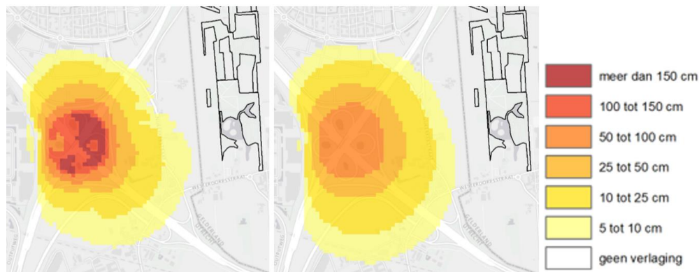
Afbeelding 18 Verlagscontouren voor de GHG (links) en de GLG (rechts)
