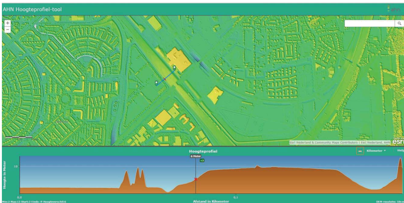
Figuur 55a-d Enkele voorbeelden van AHN profielen waarmee de hoogte van taluds ten opzichte van het omringende gebied zijn bepaald (A: A28 bij km 17; B: Knooppunt Hoevelaken; C: A 1 bij km 43.5; D: A28 bij km 35.7)
